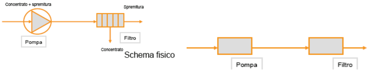
Figure 8: Sistema pompa - filtro di cui all'Esempio 6.
